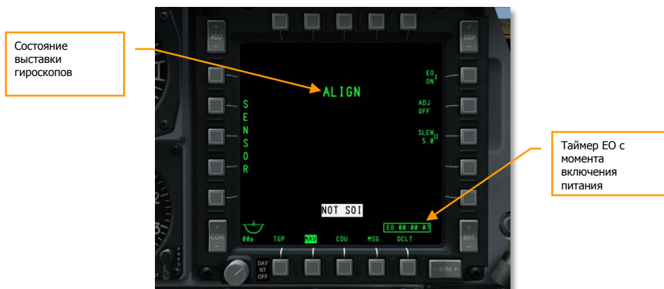
Рис. 412. Страница ракет Maverick в DSMS, согласование.
