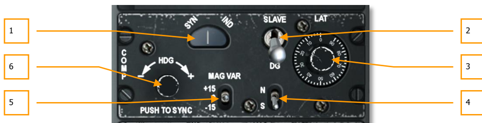
Рис 116. Панель управления HARS.
