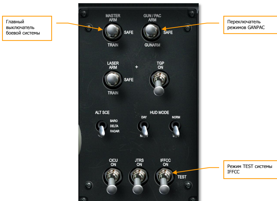
Рис. 358. Панель системы управления вооружением (АНСП).
