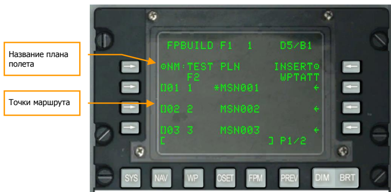
Рис. 360. Добавление точек маршрута в план полета.
