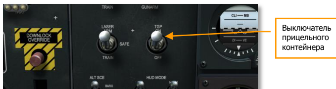
Рис. 3193. Включение прицельного контейнера.
