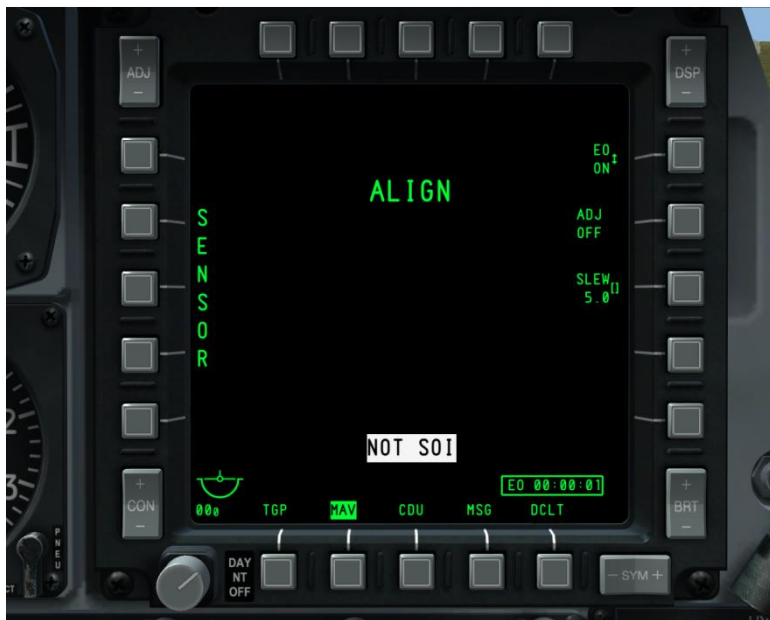
Рис. 243. Страница Maverick, согласование гироскопов.
