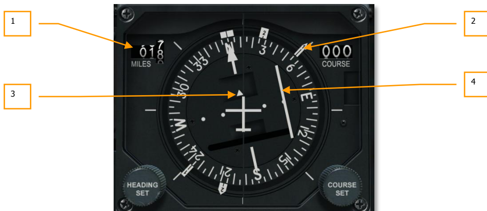
Рис. 367. Навигационная информация TACAN на ПНП.
