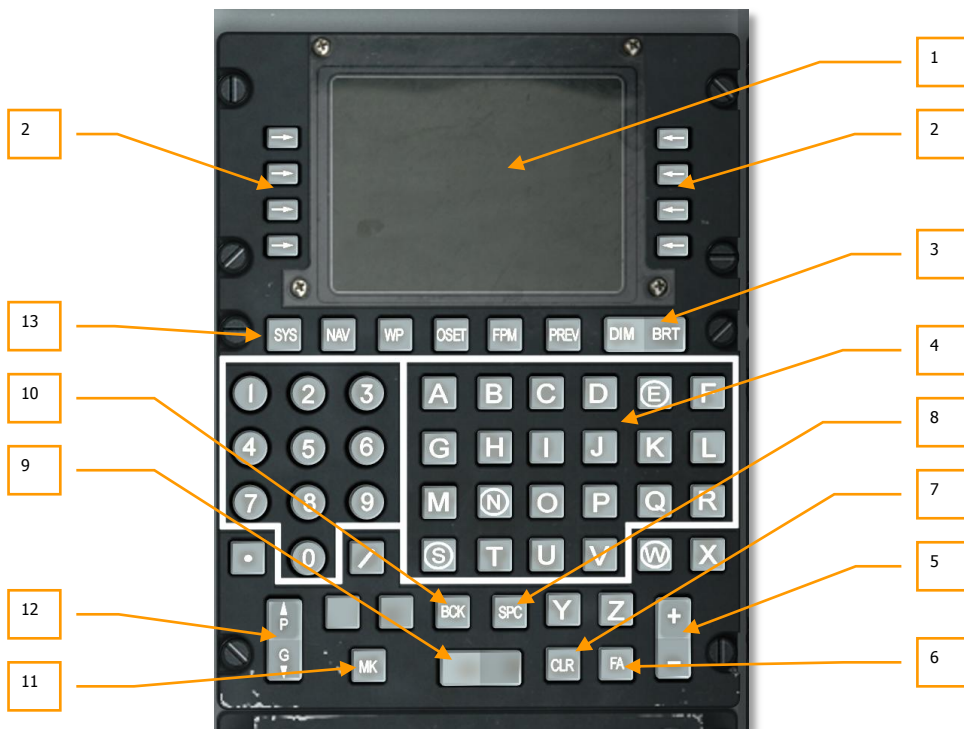
Рис. 118. Блок управления и индикации (CDU).
