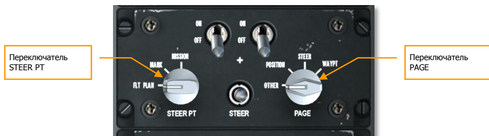
Рис. 343. Вспомогательная панель авионики (AAP).
