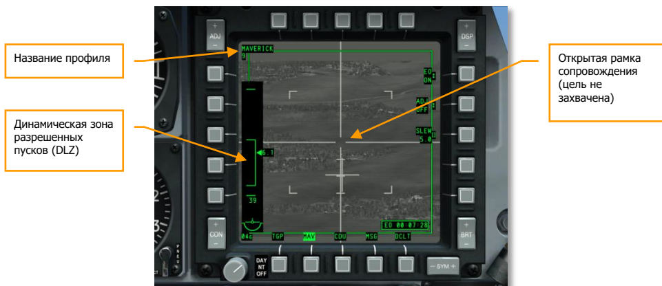
Рис. 419. Ракета Maverick в боевом режиме, без сопровождения.
