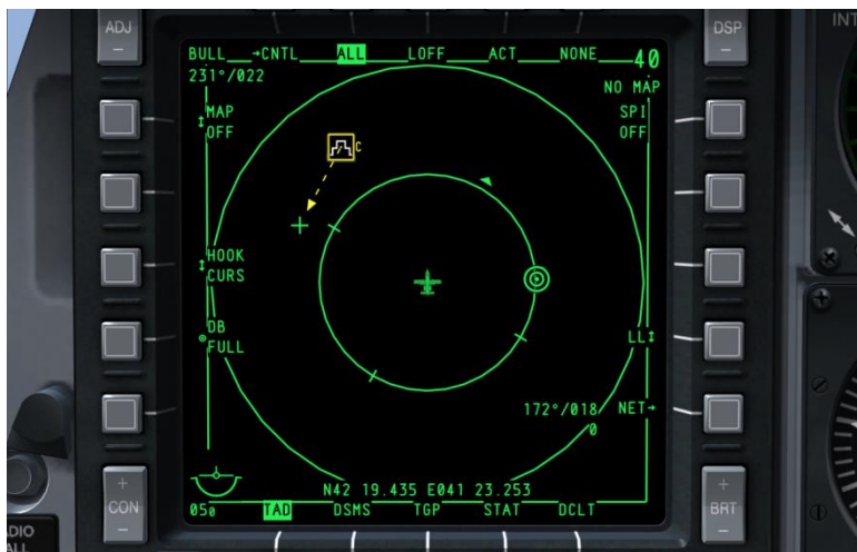
Рис 215. Режим привязки CURS на TAD.
