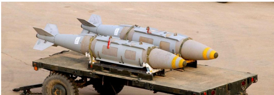
Рис 58. Авиабомба GBU-31 с инерциальным наведением.
