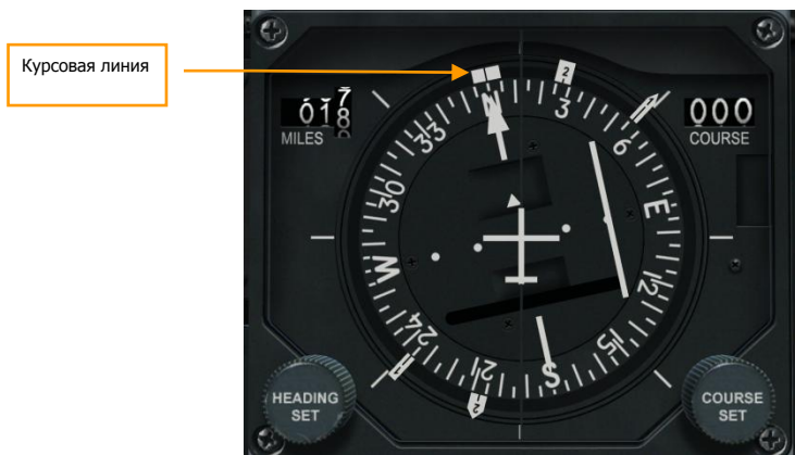
Рис. 334. Плановый навигационный прибор.
