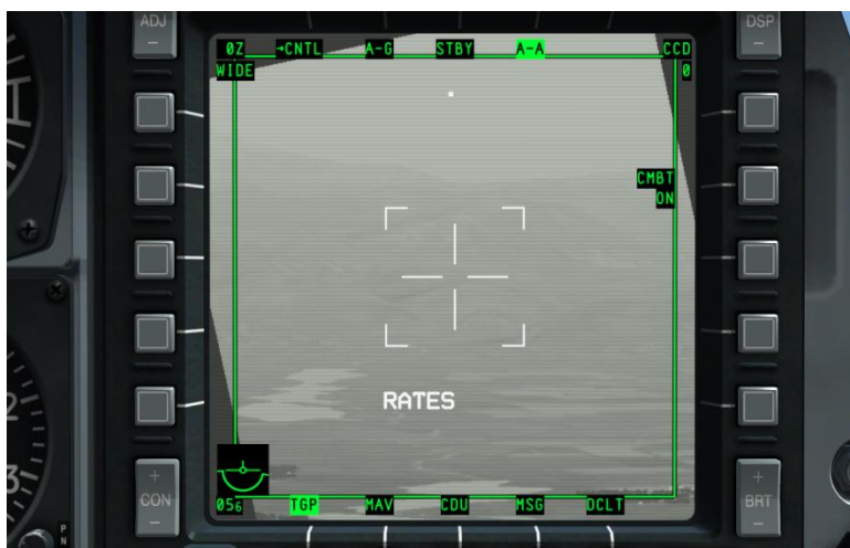
Рис. 2394. Обнаружение воздушной цели контейнером в режиме A-A.
