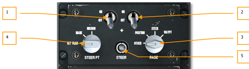
Рис. 117. Вспомогательная панель авионики (AAP).
