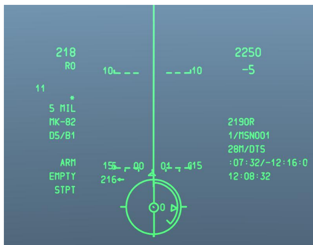
Рис 258. Момент сброса бомб в режиме CCIP CR.
