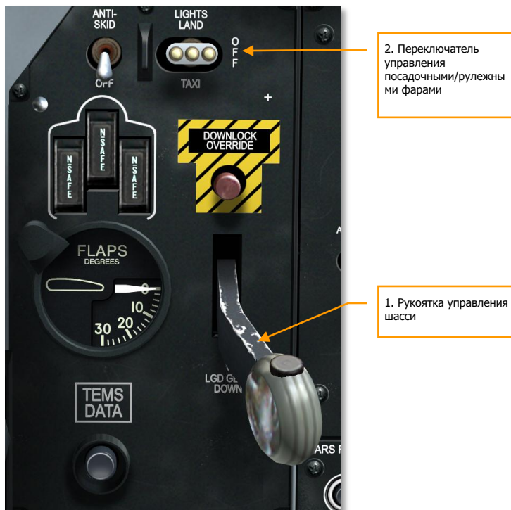
Рис. 287. Панель управления шасси и индикатор положения закрылков.
