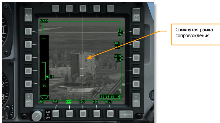
Рис. 422. Ракета Maverick в корреляционном режиме.
