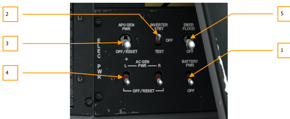
Рис. 111. Панель управления электропитанием.
