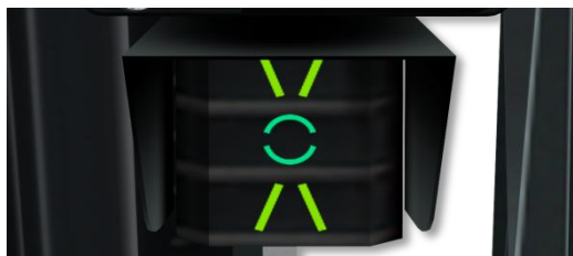
Рис. 105. Табло указателя угла атаки.
