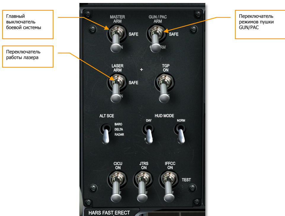
Рис. 343. Панель системы управления вооружением.
