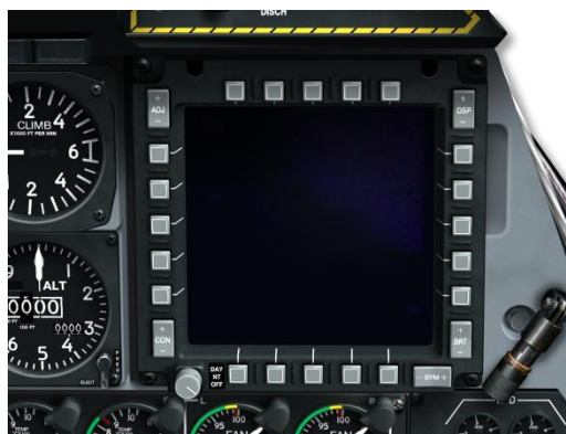
Рис. 93. Правый цветной многофункциональный индикатор.
