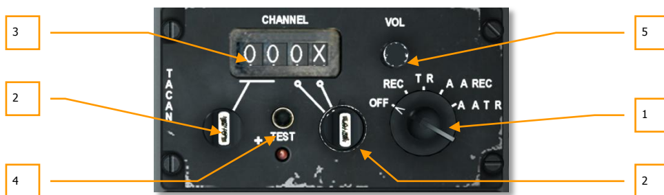
Рис. 114. Панель управления TACAN.
