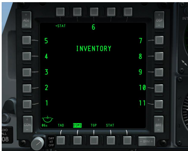
Рис. 206. Страница управления подвесками, подвески отсутствуют.
