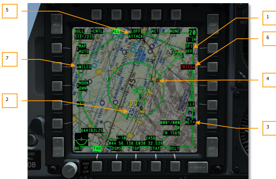
Рис. 222. Символы Datalink на TAD.
