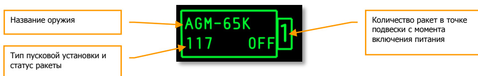
Рис. 413. Точка подвески с ракетами Maverick, питание выключено.
