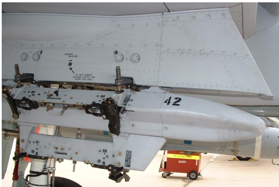
Рис. 43. Трёхзамковый балочный держатель BRU-42.
