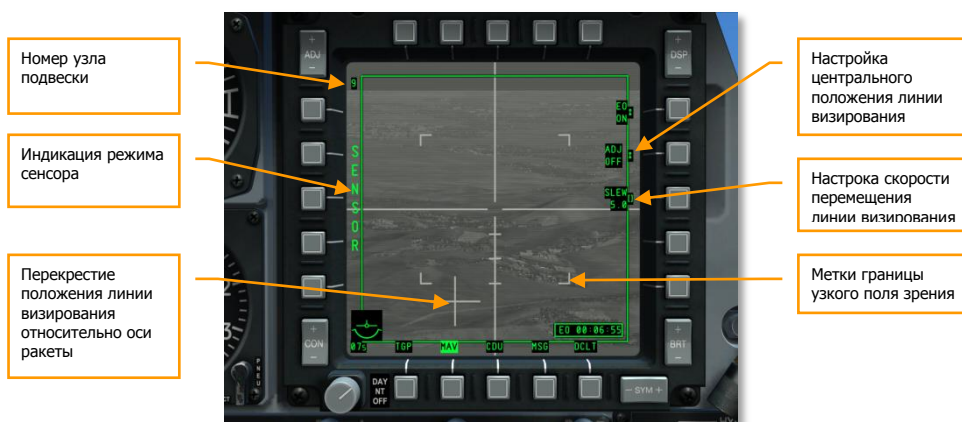
Рис. 418. Ракета Maverick в режиме сенсора.
