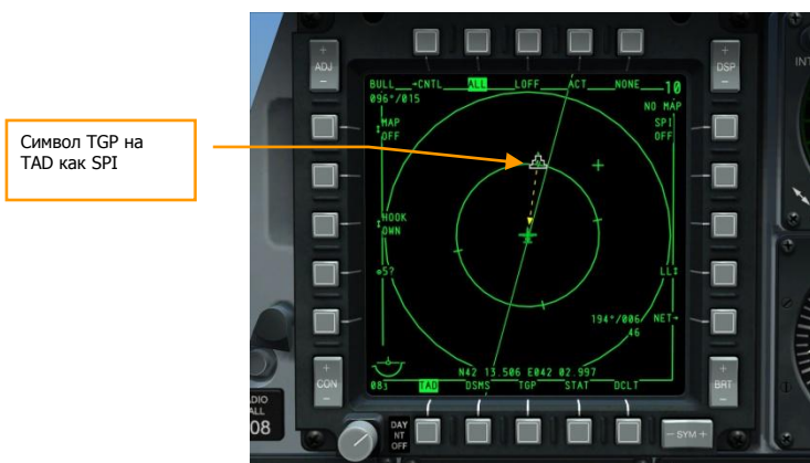
Рис. 351. Вид TAD с привязкой к SPI.
