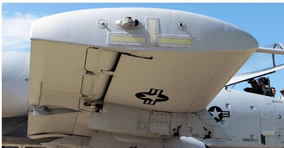
Рис. 35. Законцовка крыла и элерон.
