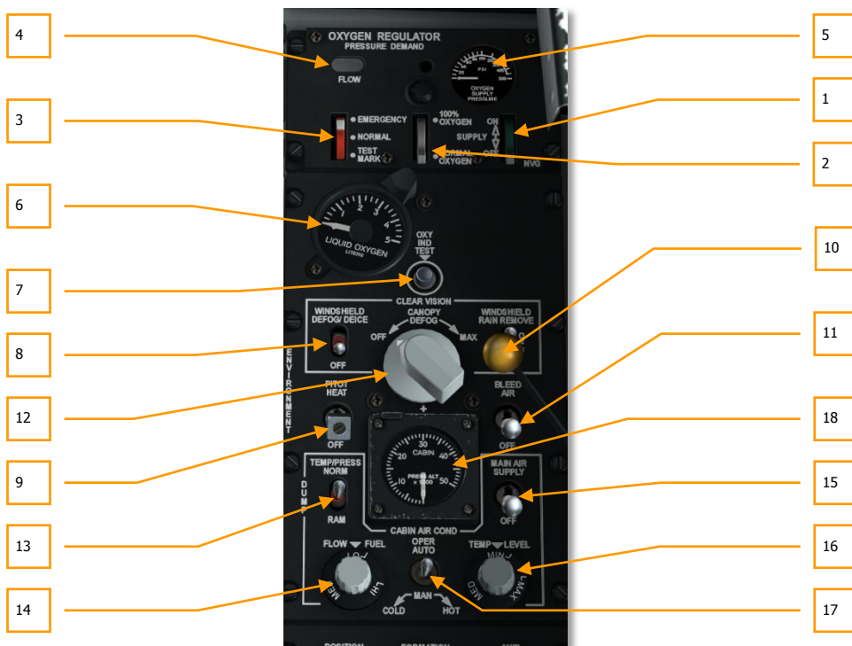
Рис. 112. Панель системы кондиционирования.
