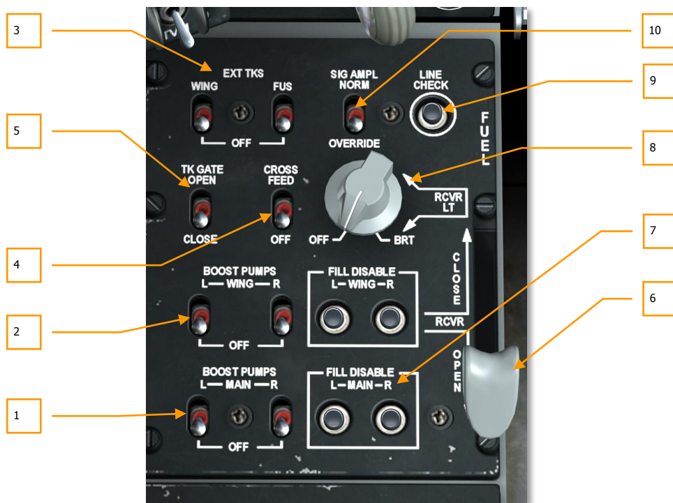
Рис. 95. Панель управления топливной системой.
