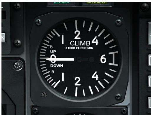
Рис. 98. Указатель вертикальной скорости.
