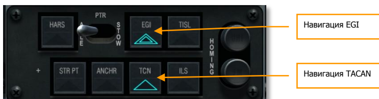
Рис. 3093. Пульт выбора навигационных режимов.
