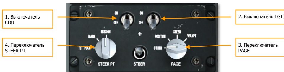
Рис. 293. Вспомогательная панель авионики.
