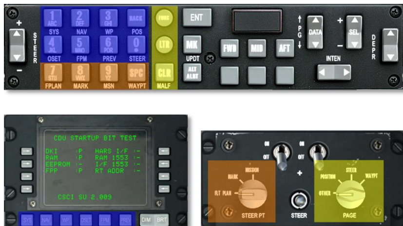
Рис. 190. Взаимосвязь между UFC и CDU/AAP.
