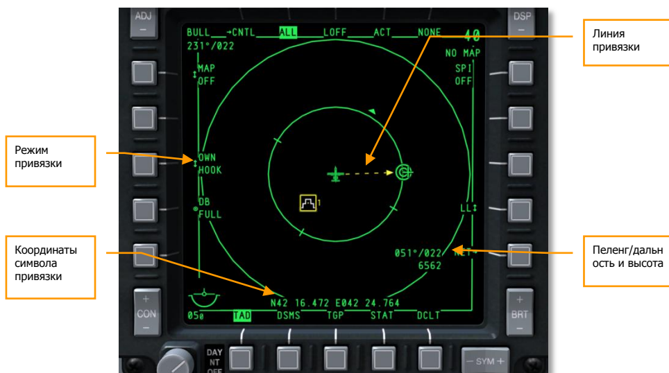
Рис 213. Режим привязки OWN на TAD (картинка не правильная).
