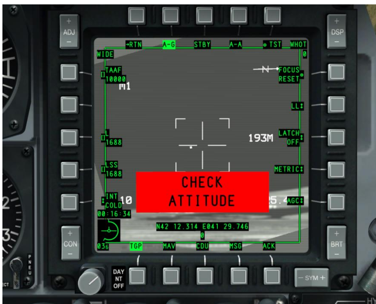
Рис. 236. Предупреждение системы TAAF в режиме A-G TGP.
