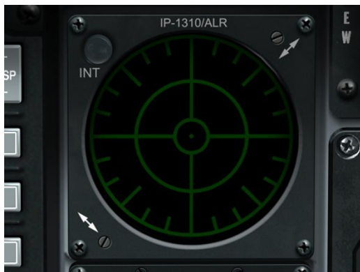
Рис. 72. Индикатор системы предупреждения об облучении.
