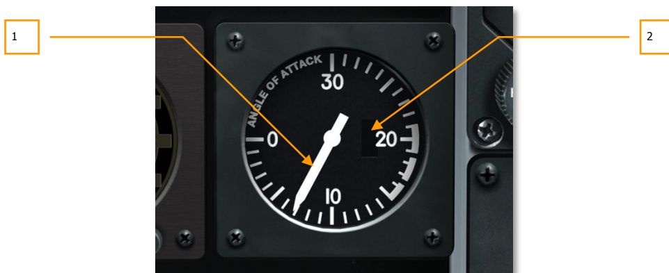
Рис. 76. Указатель угла атаки.
