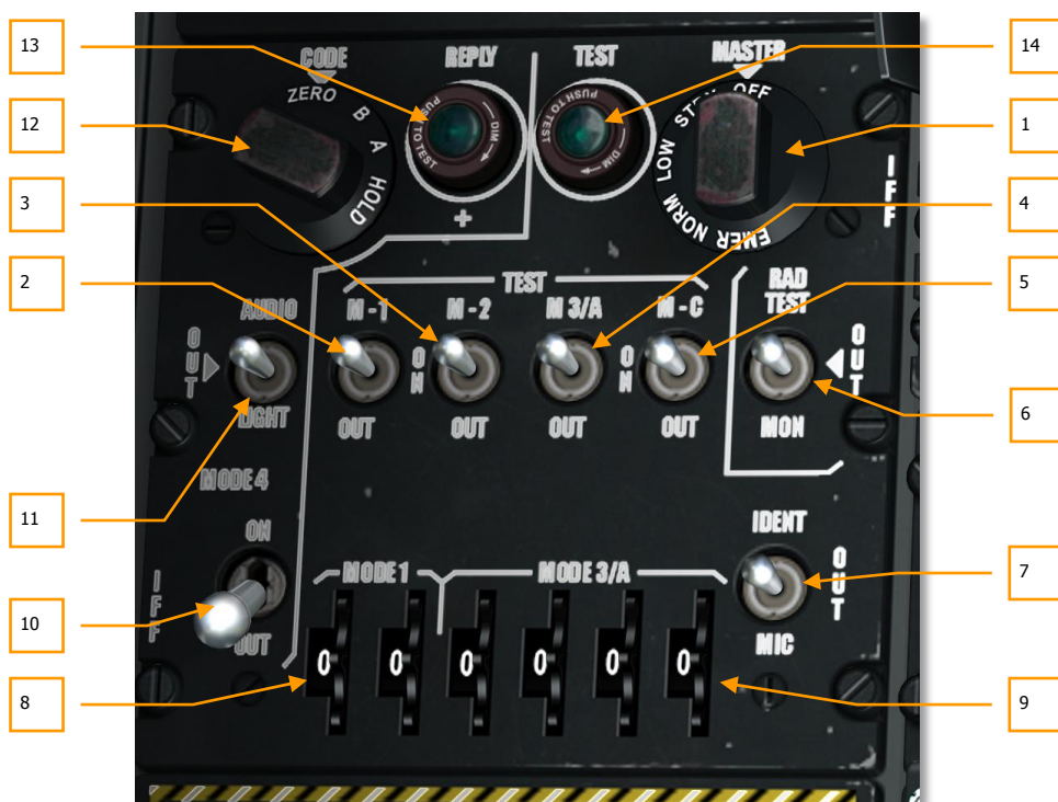
Рис. 105. Панель управления IFF/SIF
