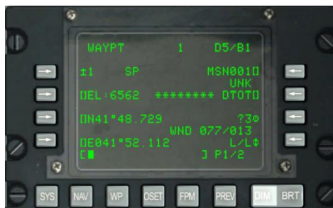
Рис. 181. Подстраница WP / WAYPOINT 1 с использованием режима навигации TO TO
