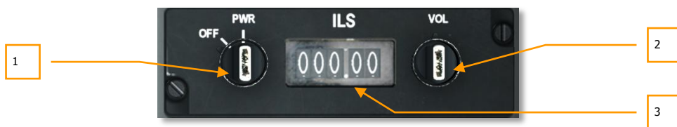
Рис. 115. Панель управления ILS.
