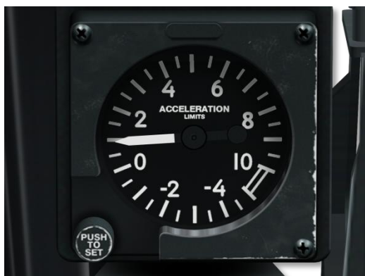
Рис. 104. Указатель перегрузки.
