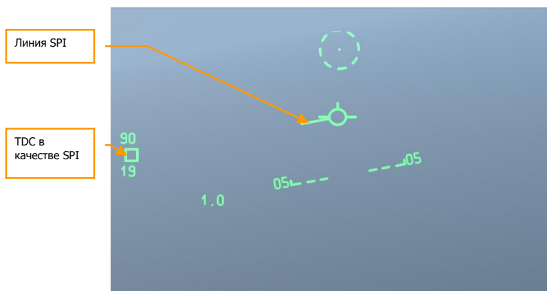
Рис. 267. TDC в качестве SPI за пределами ИЛС.
