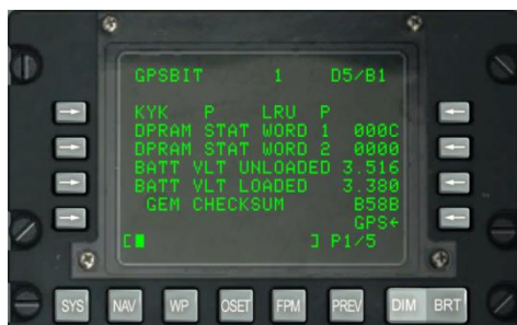
Рис. 140. Подстраница System / GPS / GPSBIT 1.
