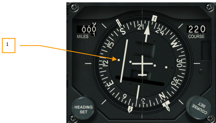
Рис. 32469. Расположение глиссады на ПНП.
