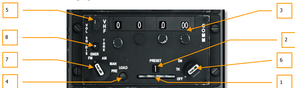
Рис. 99. Панель радиостанции ARC-186.
