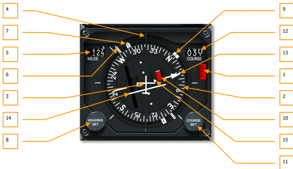
Рис. 88. Плановый навигационный прибор (HSI)
