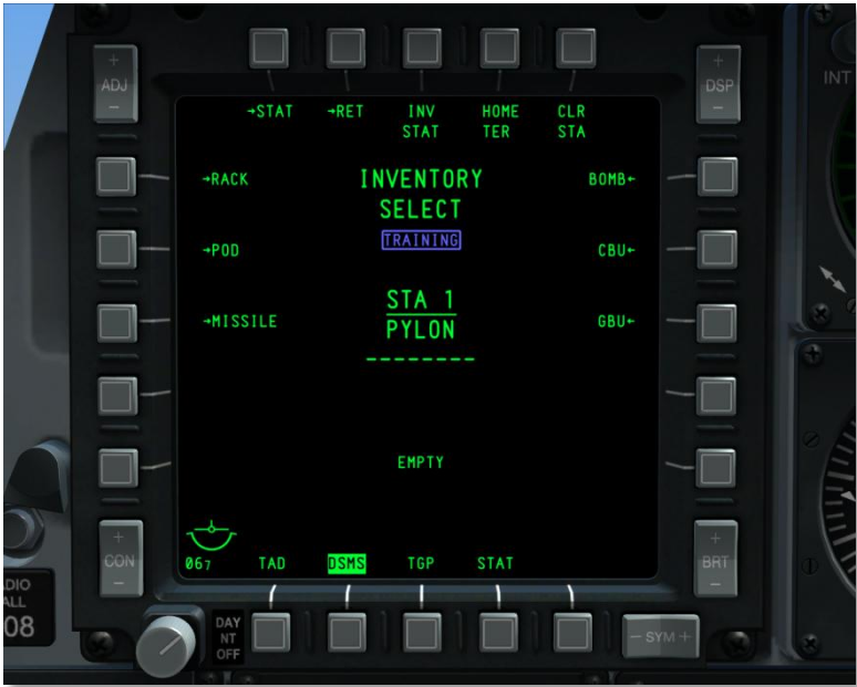
Рис. 207. Страница класса подвесок DSMS.
