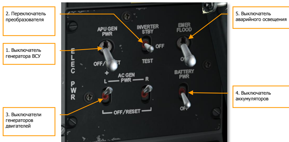
Рис. 290. Панель управления электропитанием.
