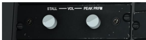
Рис. 108. Панель управления системой предупреждения о сваливании.
