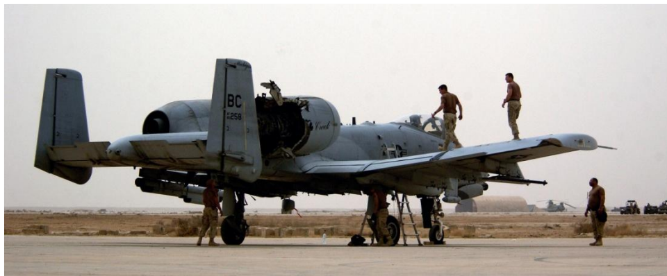
Рис. 29. Наземный персонал осматривает А-10 Thunderbolt II после попадания в него иракской ракеты.
