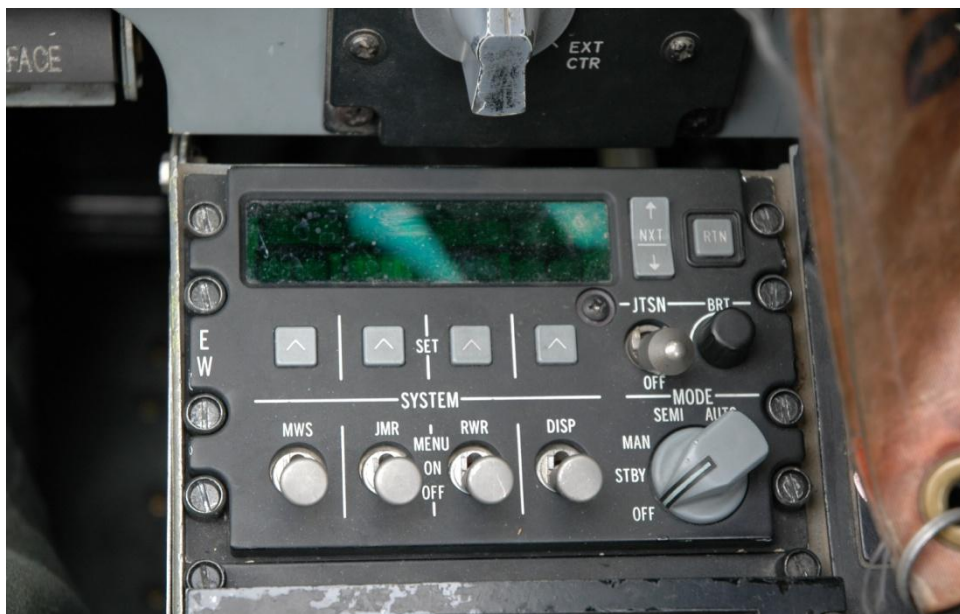
Рис. 39. Панель управления системой противодействия (CMSP).
