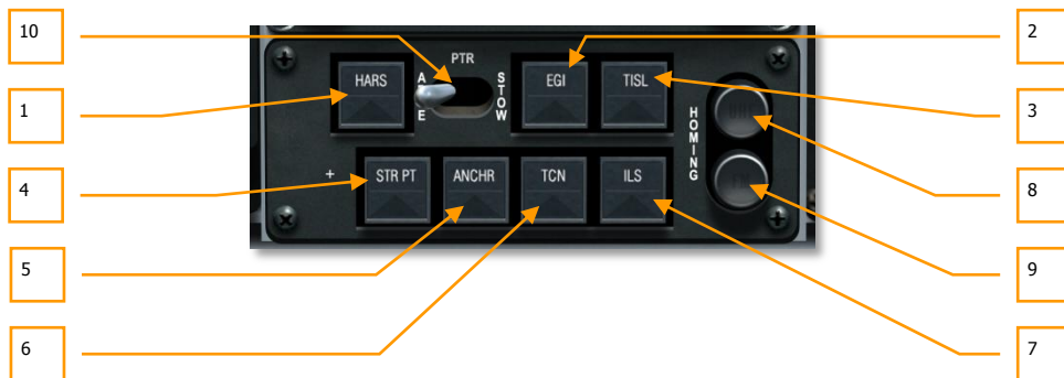
Рис. 89. Пульт выбора навигационных режимов.
