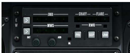
Рис. 86. Щиток управления системой противодействия.
