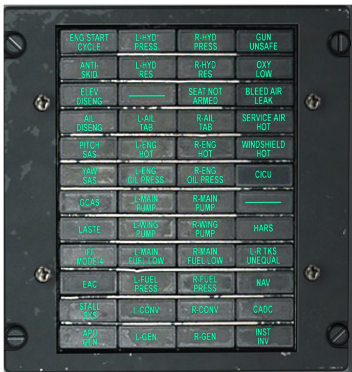
Рис. 127. Панель табло предупредительной сигнализации.
