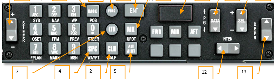
Рис. 189. Пульт ввода данных и управления (UFC).
