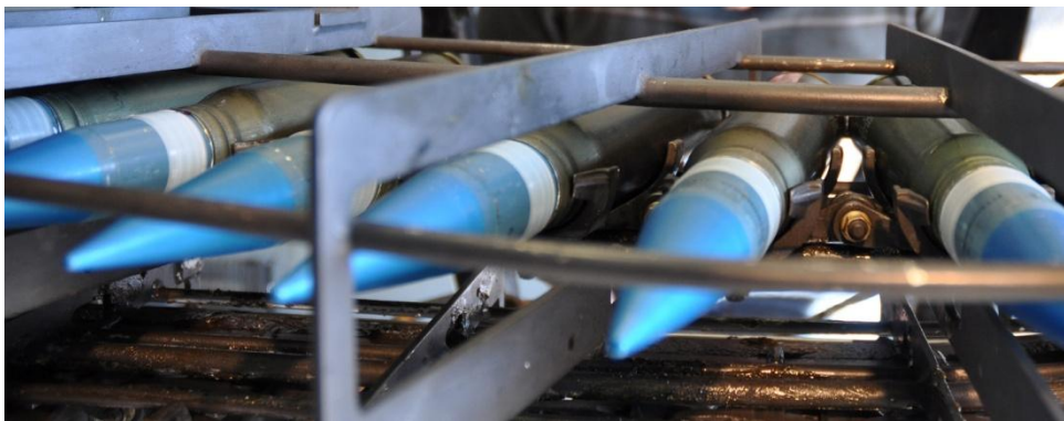
Рис. 41. 30 мм снаряды GAU-8/A.
